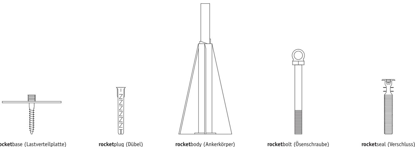
Ankersystem für WDVS, VHF u. 2-schaliges Mauerwerk zur Herstellung einer temporären Verankerung (DIN EN 12811-1:2004-03). Anwendung auf Mauerwerk und Beton. Verbleibt dauerhaft in der Fassade und kann nach entsprechender Prüfung der Ankerpunkte wiederverwendet werden.
